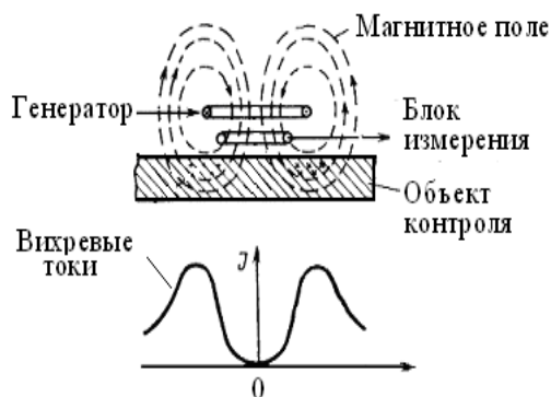
Рисунок 63 - Принцип устройства вихретокового контроля; 2 график распределения плотности вихревых токов
