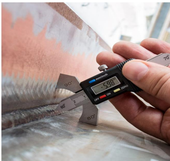
Рисунок 30 - Применение шаблона Ушера-Маршака. Измерение высоты катета углового сварного шва
