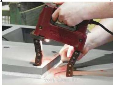
Рисунок 61 - Проверка качества сварных швов магнитопорошковой дефектоскопией (сухим способом)
