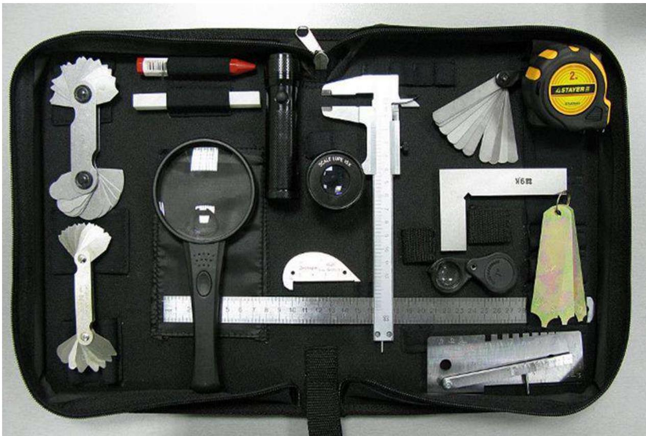
Рисунок 18 - Стандартный комплект визуального и измерительного контроля
