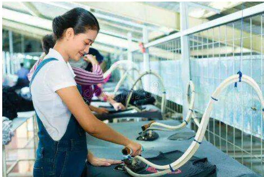
Фото 8 Влажно-тепловая обработка утюгом - глажение
